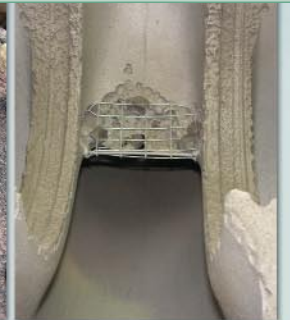
A teljesen megtisztított elhasználódott felület
