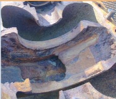
1. kép: A korrózió és az erózió nagyon jól látható
