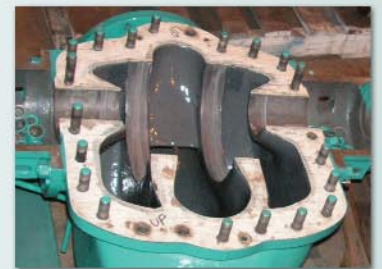
A teljesen megtisztított elhasználódott felület
