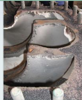
A gödrösödés és az erózió egyértelműen látható
